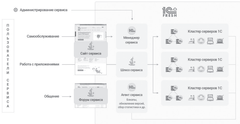
Рисунок 3. Упрощенная схема сервиса 1cFresh (представлены не все компоненты сервиса)
